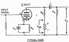
E<sub>bb</sub> R<sub>p</sub> R<sub>g</sub> R<sub>k</sub> C<sub>k</sub> C E<sub>o</sub> 300 220K 470K 420O 1.3\* 0.0074\* 78 VOLTS ohms ohms MF MF VOLTSPEAK
